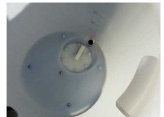
Hélice de brassage en fond de cuve
